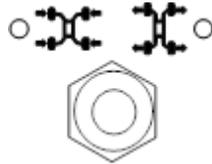
移动轴时，轴延伸和缩进指示灯将闪烁。轴完全延伸后，轴延伸指示灯将保持稳定发光状态。轴完全缩进后，轴缩进指示灯将保持稳定发光状态。
