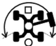
要驱动机器，请扳动驱动启用开关，并缓慢移动驱动/转向控制手柄，使它离开中心位置。
