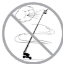
不要在风速可能超过 12.5 m/s 时升起臂杆。如果臂杆升起后风速超过 12.5 m/s，应降低臂杆并且不要继续操作机器。
